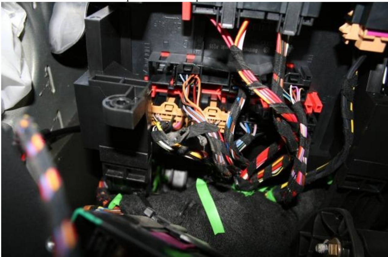
Cette photo est prise dessous donc la grosse pièce en plastique trouée est le trou pour la vis gauche du support des fusibles ....les fils qui nous intéressent sont les 2 oranges il y en un avec un liseré vert et l'autre avec un liseré marron (attention ils ne sont pas faciles à distinguer).
