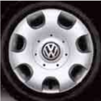
Jantes en acier 6,5J x 16 avec enjoliveurs intégraux et pneumatiques 205/55 R16. De série pour Touran Confort.
